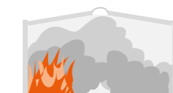
Inne mat. budowlane: często silne wydzielanie się dymu
