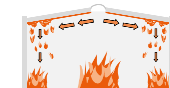
Inne mat. budowlane: rozprzestrzenianie przez wytapianie i skapywanie płonących materiałów
